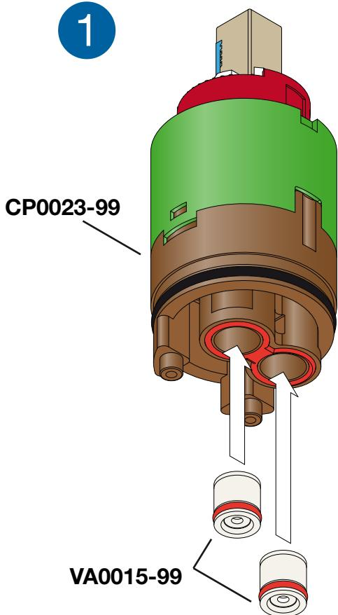
Introducir las válvulas en los alojamientos situados en las entradas de agua del cartucho como se muestra en la imagen.
