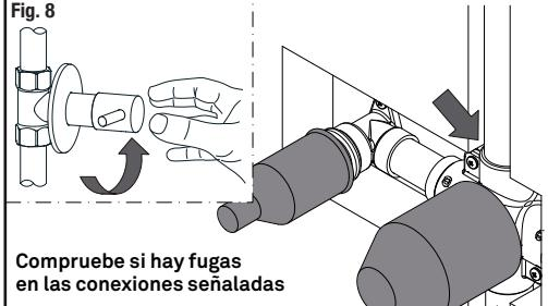
Compruebe si hay fugas en las conexiones señaladas
